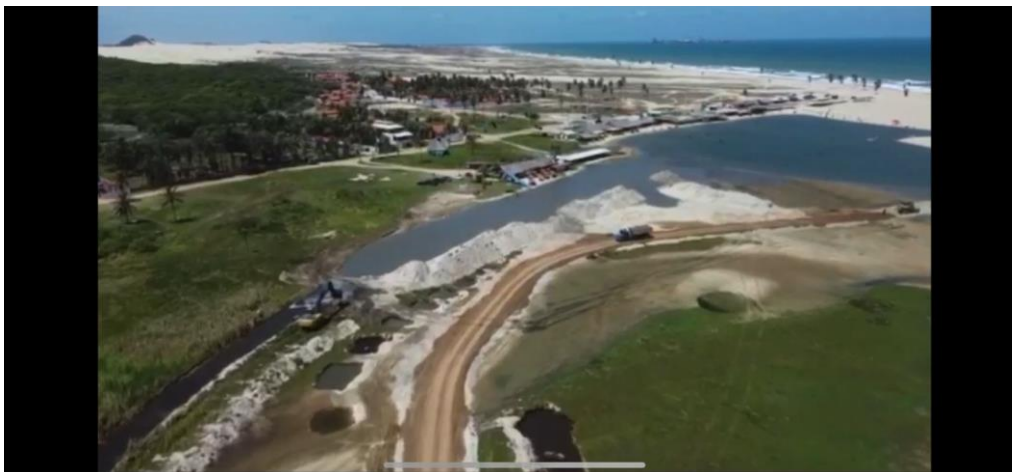
Figura 1: Imagem aérea da intervenção no Lagamar do Cauípe, demonstrando a formação de estrada.
